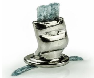
Рисунок 3 – Изображение деформированной клипсы с зажатými в ней нитями
